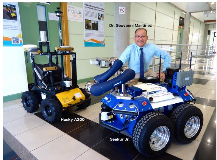
**Figura 1:** Robots usados para probar los nuevos sistemas de navegación visual desarrollados en el IPCV-LAB para robótica autónoma de exploración.
