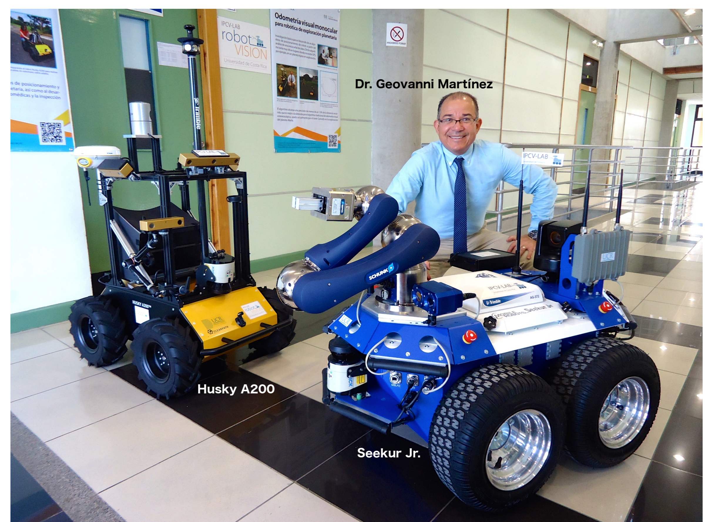
Figura 1: Robots usados para probar los nuevos sistemas de navegación basados en visión por computador, desarrollados en el IPCV-LAB para robótica autónoma de exploración.
