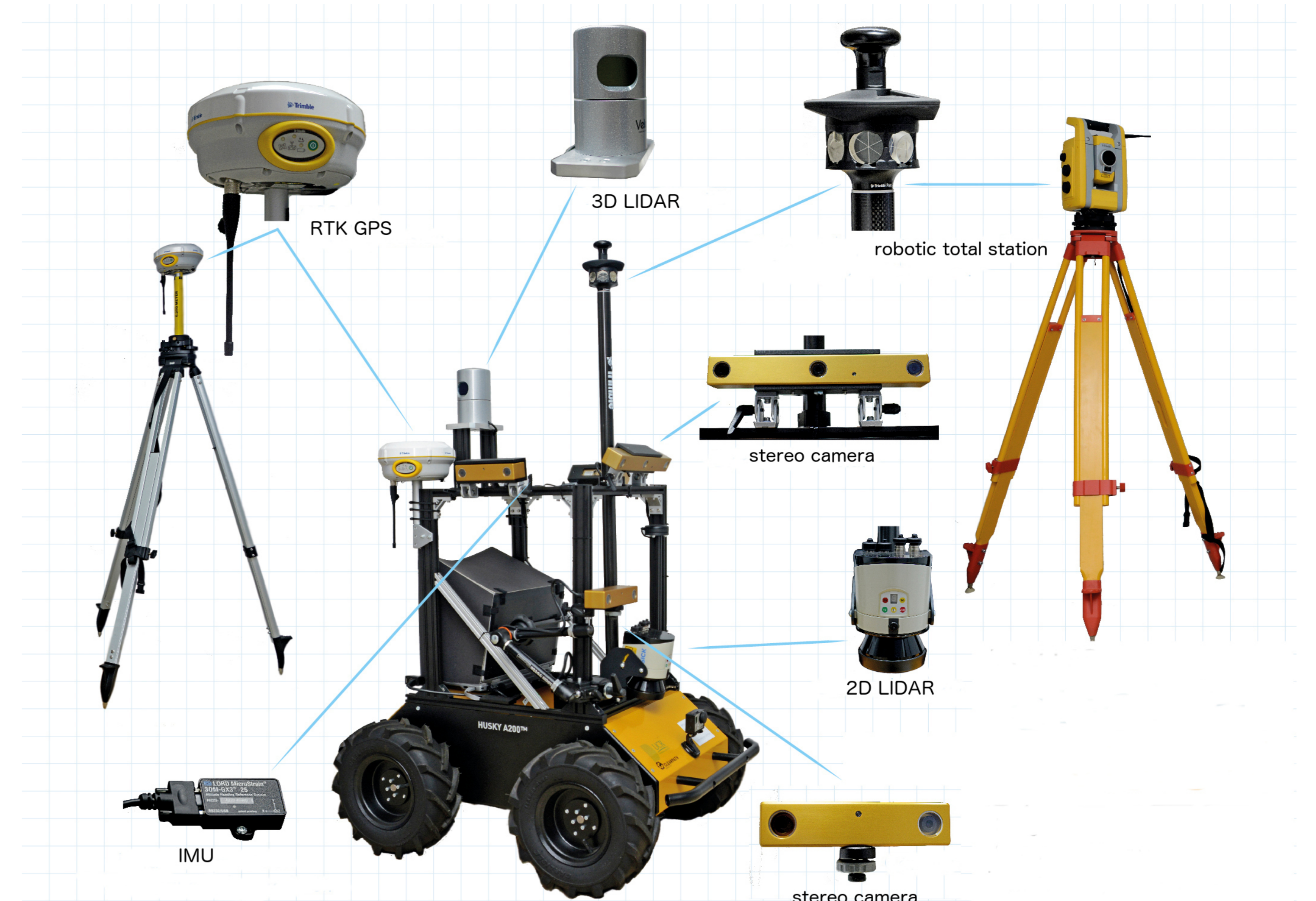
Figura 2: Sistemas de posicionamiento satelital (RTK GPS) y láser robótico (robotic total station) de alta precisión, escáner láser tridimensional (3D LIDAR), escáner láser bidimensional (2D LIDAR), cámaras estereoscópicas (stereo cameras) y unidad de medida inercial (IMU) usadas para la validación de los nuevos sistemas de navegación visual desarrollados en el IPCV-LAB para robótica autónoma de exploración.
