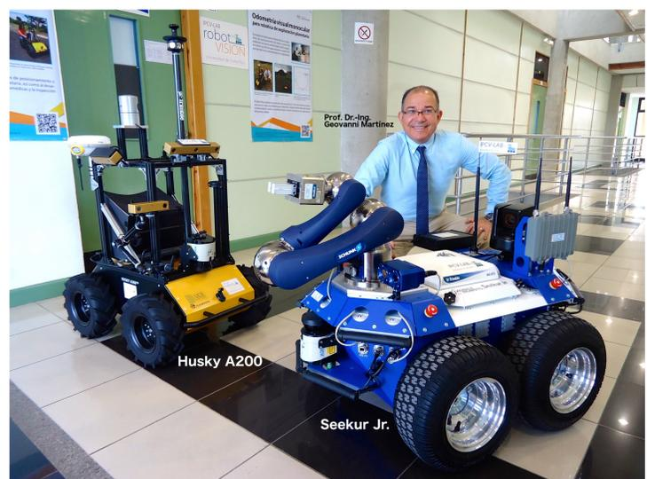
Figura 1: Robots usados para probar la nueva tecnologías de odometría y SLAM NIR ToF monocular desarrolladas por el IPCV-LAB para sistemas de navegación de robot autónomos de exploración.
