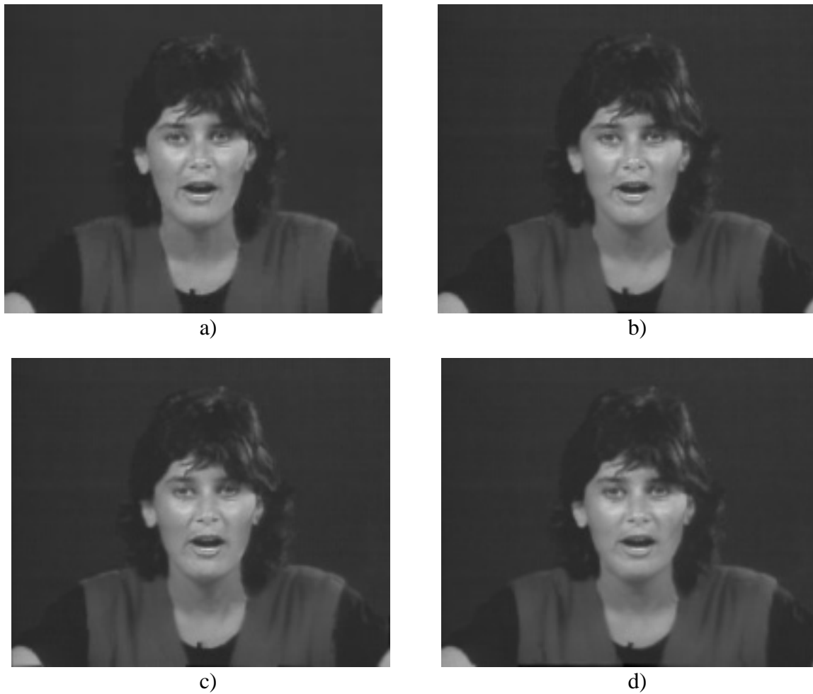
Bild 7.4 Codierergebnisse zu Bild 7.1.b für verschiedene Quellenmodelle: a) blockbasierter Hybridcoder TMN5 mit 50 kbit/s, b) R3D mit 64 kbit/s, c) F3D mit 56 kbit/s und d) A3D 50 kbit/s. Testsequenz Miss America .
