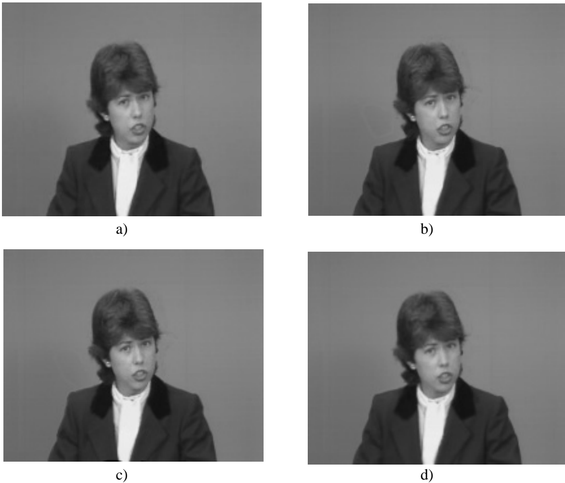
Bild 7.3 Codierergebnisse zu Bild 7.1.a für verschiedene Quellenmodelle: a) blockbasierter Hybridcoder TMN5 mit 50 kbit/s, b) R3D mit 64 kbit/s, c) F3D mit 56 kbit/s und d) A3D 50 kbit/s. Testsequenz Claire .
